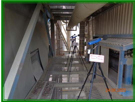
ภาพถ่ายการตรวจวัดระดับเสียงในสถานที่ทำงาน บริเวณ SP 5 Boiler ชั้น 4
