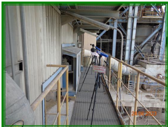
ภาพถ่ายการตรวจวัดระดับเสียงในสถานที่ทำงาน บริเวณ SP 5 Boiler ชั้น 6
