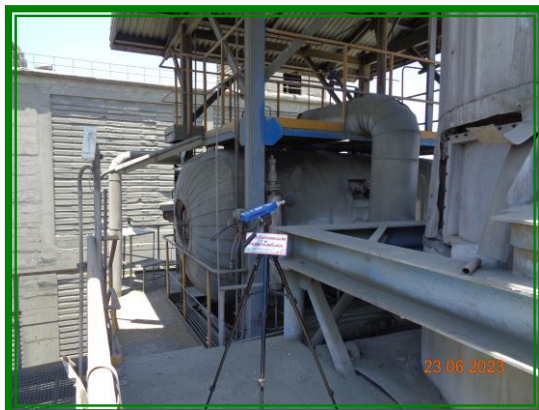
ภาพถ่ายการตรวจวัดระดับเสียงในสถานที่ทำงาน บริเวณ AQC 5 Boiler ชั้น 9
