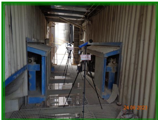
ภาพถ่ายการตรวจวัดระดับเสียงในสถานที่ทำงาน บริเวณ SP 5 Boiler ชั้น 8
