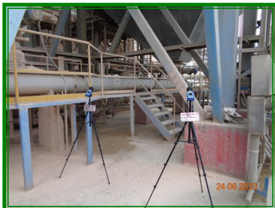
ภาพถ่ายการตรวจวัดระดับเสียงในสถานที่ทำงาน บริเวณ SP 5 Boiler ชั้น 2
